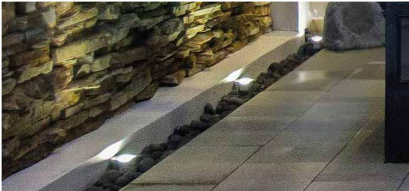
Incasso con dissipatore e ghiera in acciaio 316L tornito, LED WICOP per illuminazione diffusa d'accento, decorazione, cortesia o segna passo. Diffusore opalino. Installabile a pavimento e a parete in ambienti interni ed esterni, montaggio con cassaforma.
